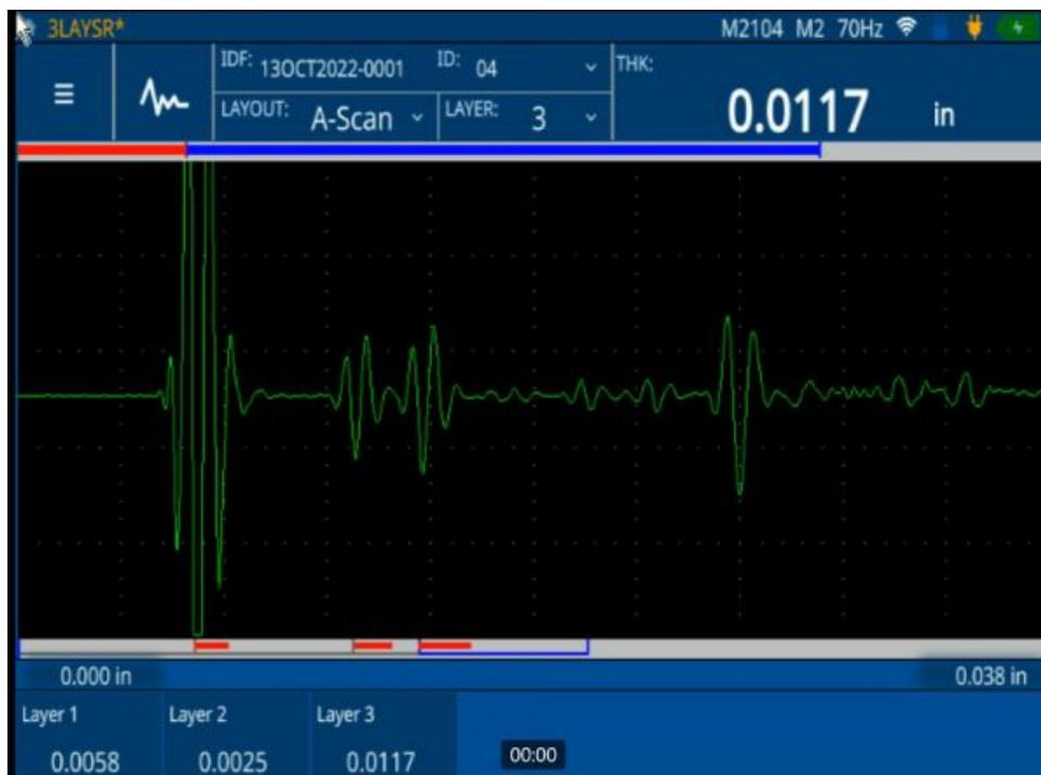
Mesure d'un contenant en plastique à trois couches prise à 50 MHz avec le mesureur d'épaisseur à ultrasons 72DL PLUS
